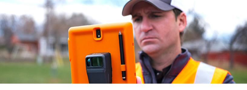
THE SPIKE LASER DEVICE CONNECTS WITH YOUR SMARTPHONE OR TABLET VIA BLUETOOTH. SPIKE'S LASER RANGEFINDER WORKS JOINTLY WITH YOUR SMARTPHONE OR TABLET'S CAMERA, GPS, COMPASS, AND CONNECTION TO THE INTERNET.
